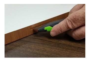
e) INSERT JOINING BISCUITS INTO ELONGATED SLOTS OF ONE TOP HALF
