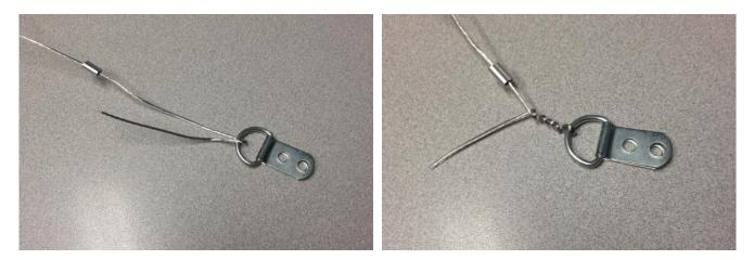
e) SLIDE WIRE CRIMP SLEEVE OVER SHORT END OF WIRE
